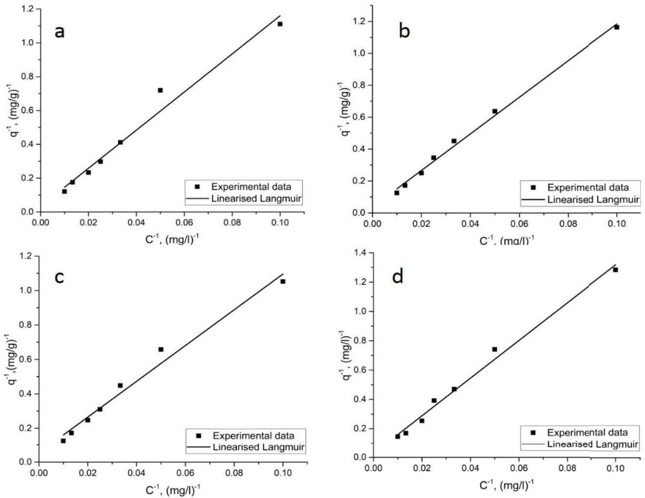
Fig. 15. Langmuir adsorption isotherm: (a) Cr(VI)-Fe(III), (b) Cr(VI)-Fe(III)-Ni(II), (c) Cr(VI)-Fe(III)-Ni(II)-Zn(II), and (d) Cr(VI)-Fe(III)-Ni(II)-Zn(II)-Cu(II) systems.
