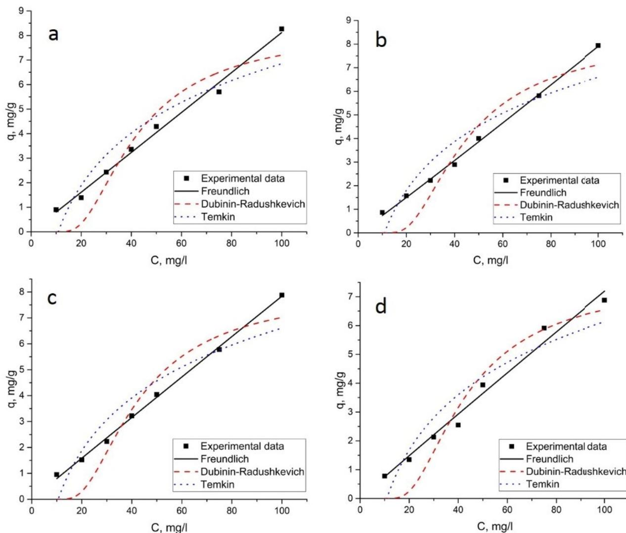
Fig. 14. Adsorption isotherms: (a) Cr(VI)-Fe(III), (b) Cr(VI)-Fe(III)-Ni(II), (c) Cr(VI)-Fe(III)-Ni(II)-Zn(II), and (d) Cr(VI)-Fe(III)-Ni(II)-Zn(II)-Cu(II) systems.
