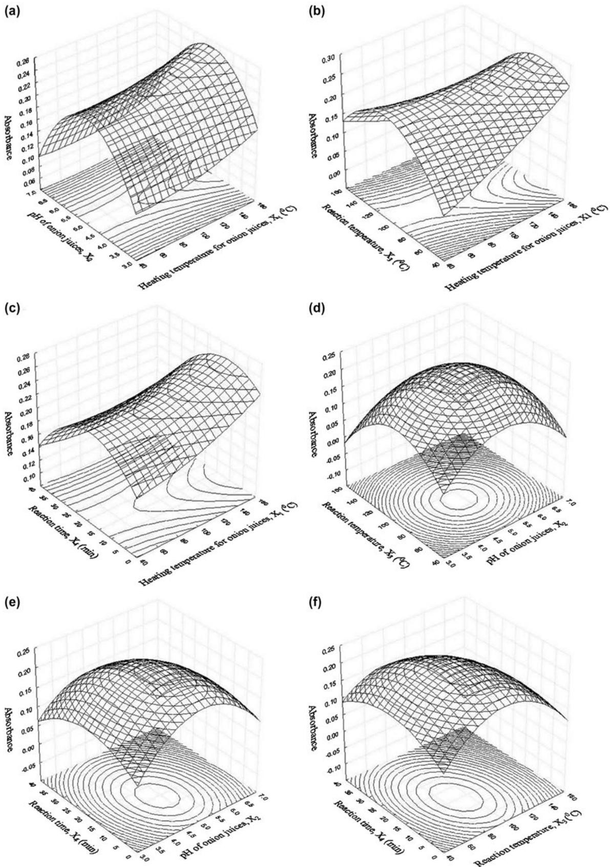
Fig. 2. The 3D response surface plots for the effects of parameters affecting formaldehyde determination by Box–Behnken design. (a)  $X_1X_2$ ; (b)  $X_1X_3$ ; (c)  $X_1X_4$ ; (d)  $X_2X_3$ ; (e)  $X_2X_4$ ; (f)  $X_3X_4$ .
