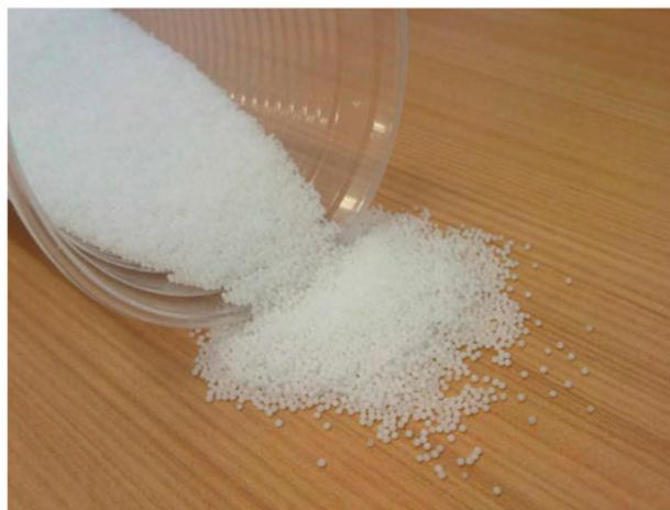
Fig. 1. Polystyrene granules.
