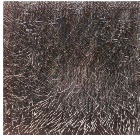
Fig. 2. Pin fins absorber plate.
