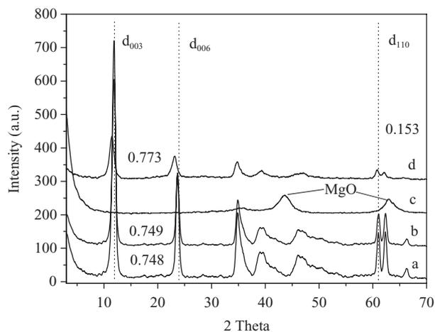
Fig. 6. Powder XRD patterns for (a) MgAl- $\text{CO}_3$  LDHs, (b) LDHs after chloride removal, (c) CLDH, (d) CLDH after chloride removal.
