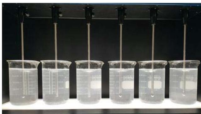
Fig. S2. Jar test apparatus.
