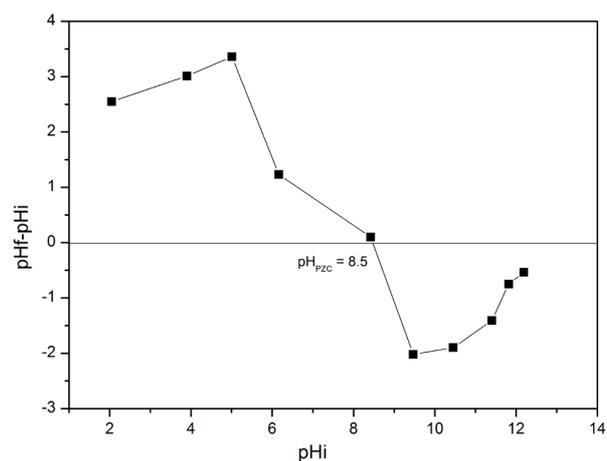
Fig. 3. pH<sub>ZPC</sub> of natural pozzolan.
