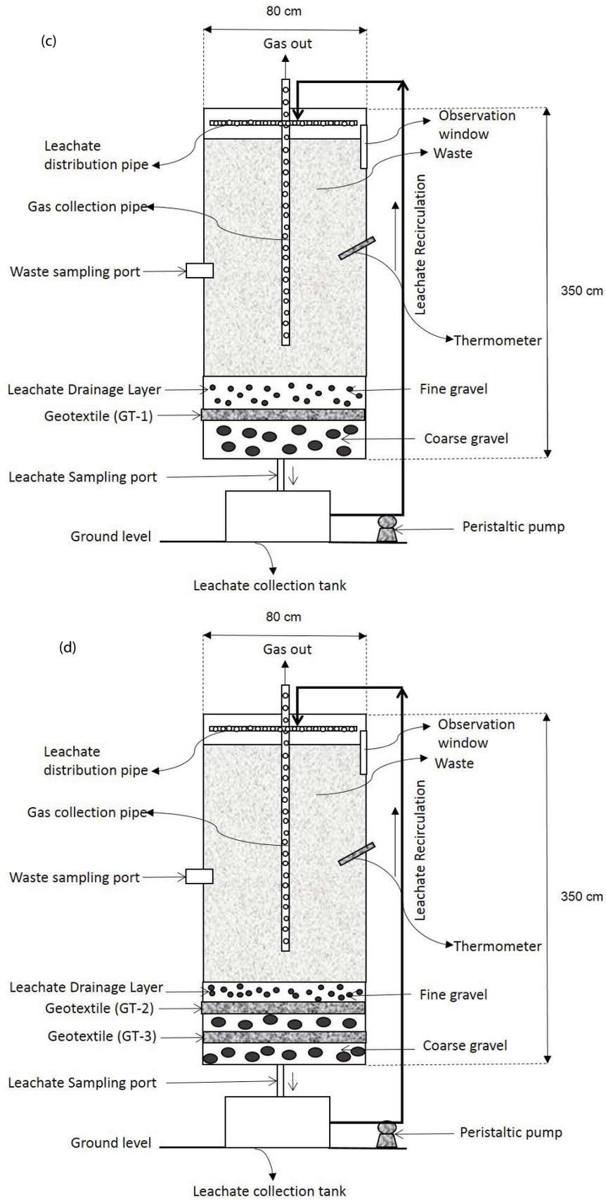
Fig. 1. (a) Schematic diagram of reactor R1, (b) R2, (c) R3, and (d) R4.
