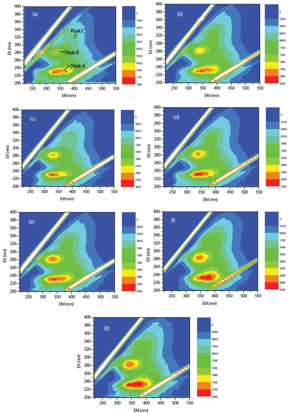
Fig. 4. Effect of SDS dosage on EEM profile of the released fluorophores: (a) raw sludge, (b) 0.025 g g<sup>-1</sup> DS, (c) 0.05 g g<sup>-1</sup> DS, (d) 0.075 g g<sup>-1</sup> DS, (e) 0.1 g g<sup>-1</sup> DS, (f) 0.15 g g<sup>-1</sup> DS, and (g) 0.2 g g<sup>-1</sup> DS.
