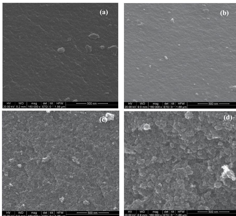
Fig. 4. SEM images of carbon xerogels, (a) CX, (b) CXN-0.1, (c) CXN-0.5, and (d) CXN-1.
