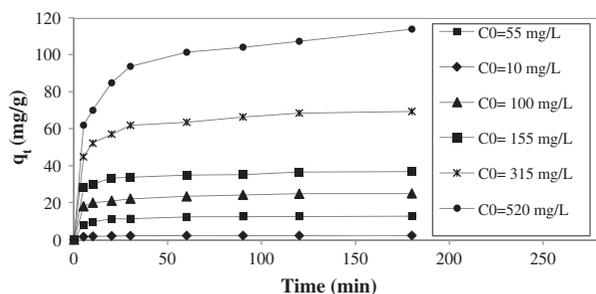
Fig. 2. Adsorption capacity evolution at various initial MB concentrations ( $T=293\text{ K}$ ;  $W=400\text{ mg}$ ;  $\text{pH}=12$ ;  $N=500\text{ rpm}$ ).
