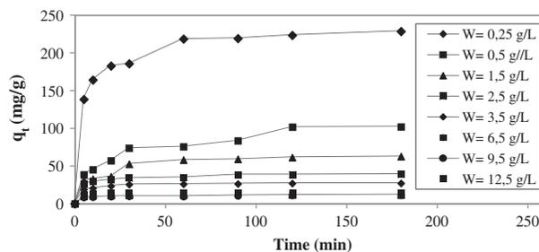
Fig. 3. Adsorption capacity evolution at various adsorbent doses ( $T=293\text{ K}$ ;  $C_0=100\text{ mg/L}$ ;  $\text{pH}=12$ ;  $N=500\text{ rpm}$ ).
