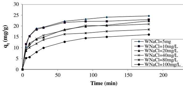
Fig. 5. Adsorption capacity evolutions at various ionic strengths ( $T=293\text{ K}$ ;  $C_0=100\text{ mg/L}$ ;  $\text{pH}=12$ ;  $N=500\text{ rpm}$ ;  $W=400\text{ mg}$ ).
