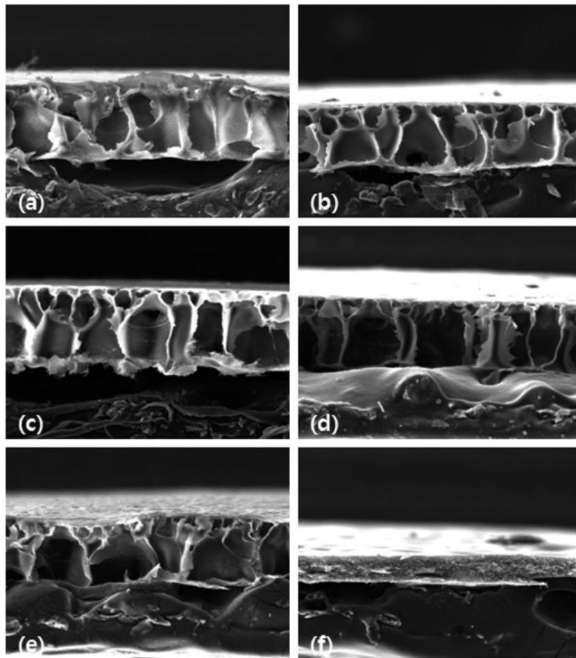
Fig. 6. Effect of 1,4-dioxane on morphology of AMC membranes; (a) D60 (b) D50 (c) D40 (d) D30 (e) D20 (f) D10.
