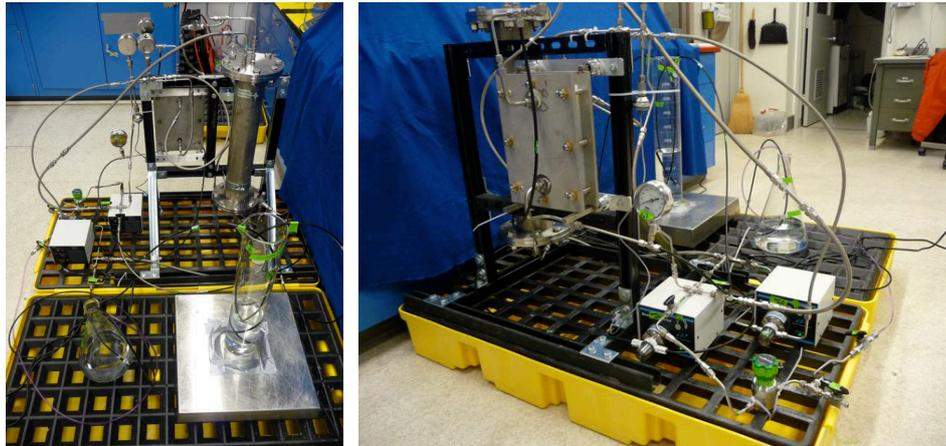
Fig. 2. FO power membrane test rig.
