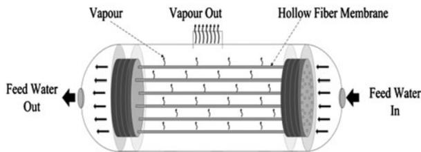
Fig. 3. VMD Module Diagram.
