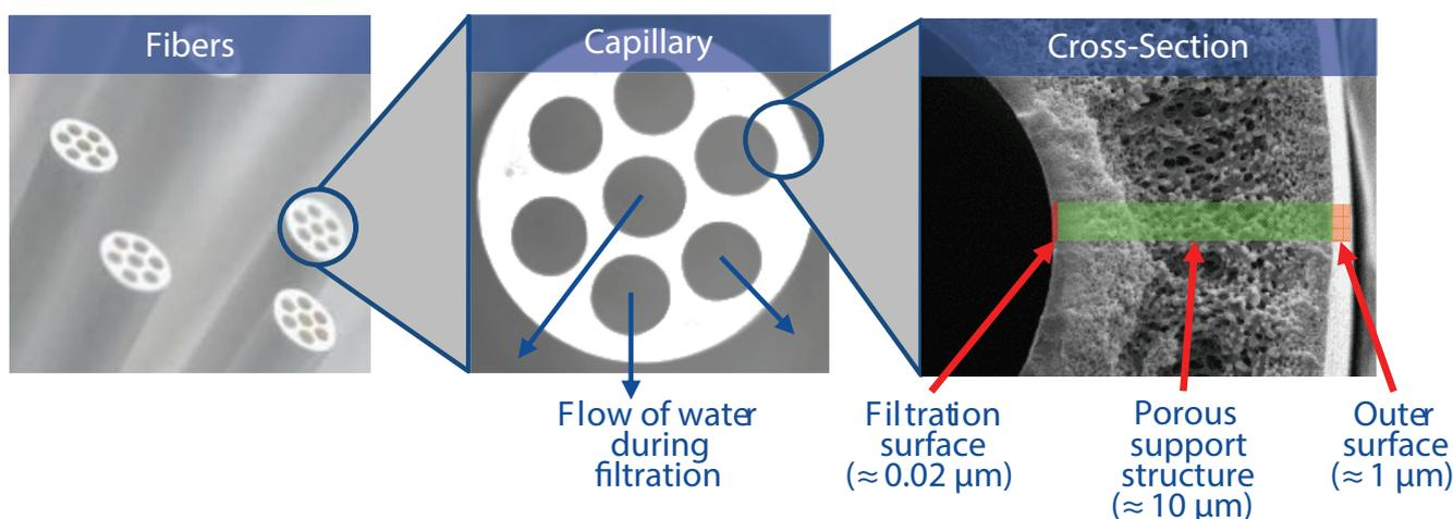
Fig. 2. Multibore<sup>®</sup> membrane.
